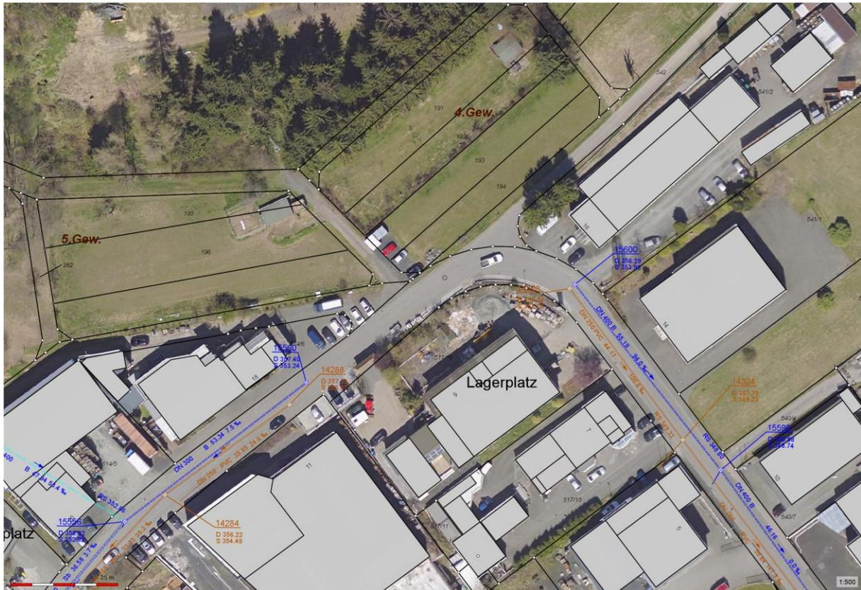
Abb. 3.: Vorhandene Entwässerung, Trennsystem
