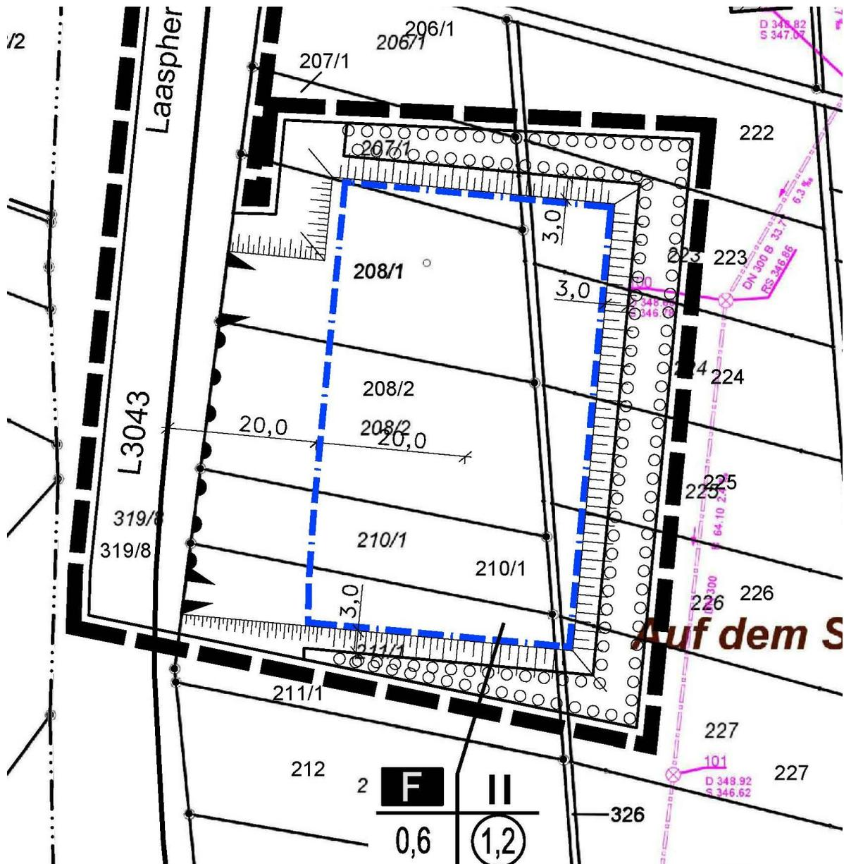
Abb. 11: Auszug aus dem Lageplan der Kanalisation mit Eintrag des Bebauungsplanes
